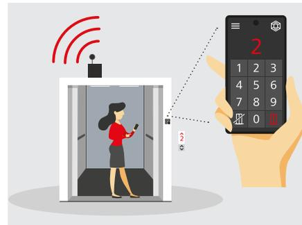
Nun wird einfach das gewünschte Zielstockwerk in der Handy-App ausgewählt. Anschließend kommt die Aufzugskabine und bringt die Fahrgäste, ohne weitere Interaktion mit dem Aufzug, in die ausgewählte Etage.
