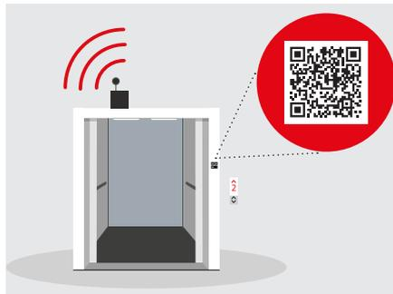
An jedem Türrahmen wird ein individueller QR Code Sticker angebracht. Dieser wird von Schindler konfiguriert und ermöglicht den Aufzugsruf, wenn man sich in unmittelbarer Nähe zum Aufzug befindet. So werden Störungen vermieden.
